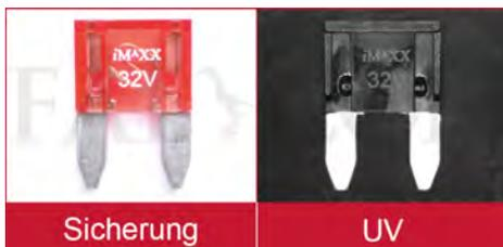
Durch UV werden metallische Oberflächen stark Reflektiert und Kunststoff weniger durchleuchtet. Beschädigungen auf der Oberfläche lassen sich somit besser darstellen als z.B. unter **infrarotem Licht**
