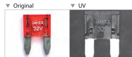
Durch UV werden metallische Oberflächen stark reflektiert und Kunststoff weniger durchleuchtet. Beschädigungen auf der Oberfläche lassen sich somit besser darstellen als z.B. unter infrarotem Licht (Beispiel Seite 61)
