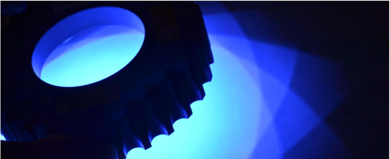
Ultraviolette-Beleuchtungen (UV) werden eingesetzt um beispielsweise Kleber anzuregen, UV-Markierungen sichtbar zu machen oder zur Überprüfung von Lötstellen auf der Leiterplatte.
