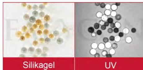
Der Kontrastunterschied wird unter UV deutlich verstärkt. Somit kann zwischen feuchten (dunkel) und trockenen (hell) Kieselgels einfacher unterschieden werden.
