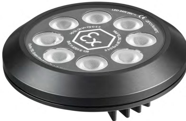
Der EX-High-Power-LED-Strahler ist eine robuste, kompakte Aufbauleuchte mit hoher Leistung. Seine Bauart und Eigenschaften ermöglichen den Betrieb in kritischer Umgebung, als auch eine konstante Helligkeit der Leuchte bei schwankender Betriebsspannung. Als LED-Leuchte der HPLS-Familie besitzt der EX-HPLS alle Features des Grundmodells (Integriertes 24V-Netzteil, vollvergossene Elektronik, aktives- und passives Thermomanagement).
