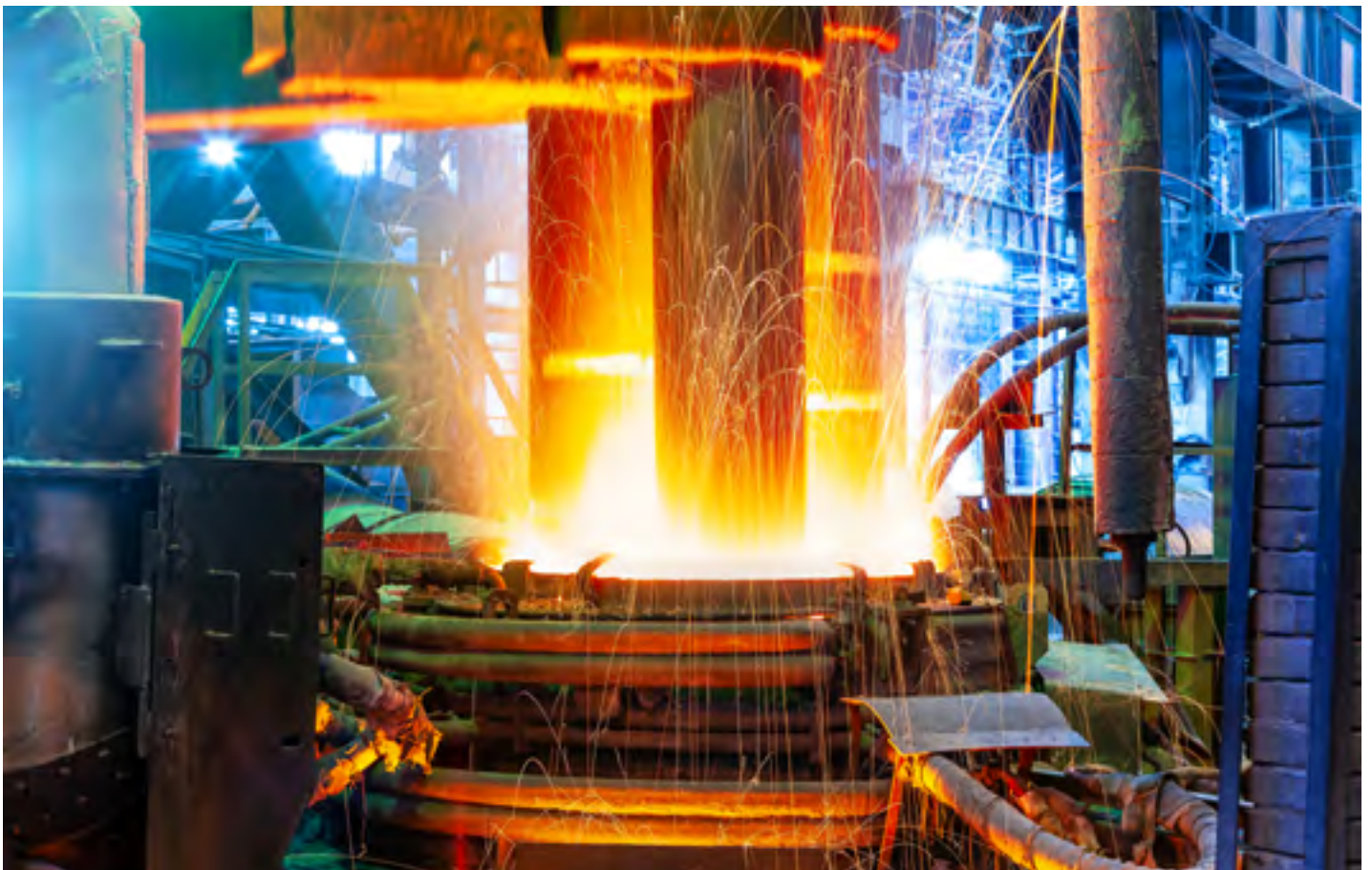
Elektrlichtbogenofen in Werkstatt für Metallurgie-Anlagen
